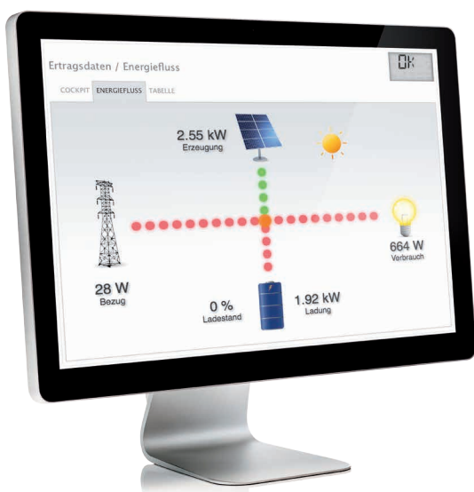
Mit Hilfe des Energieflusses kann die Verwendung des selbst erzeugten Stroms visualisiert werden.
