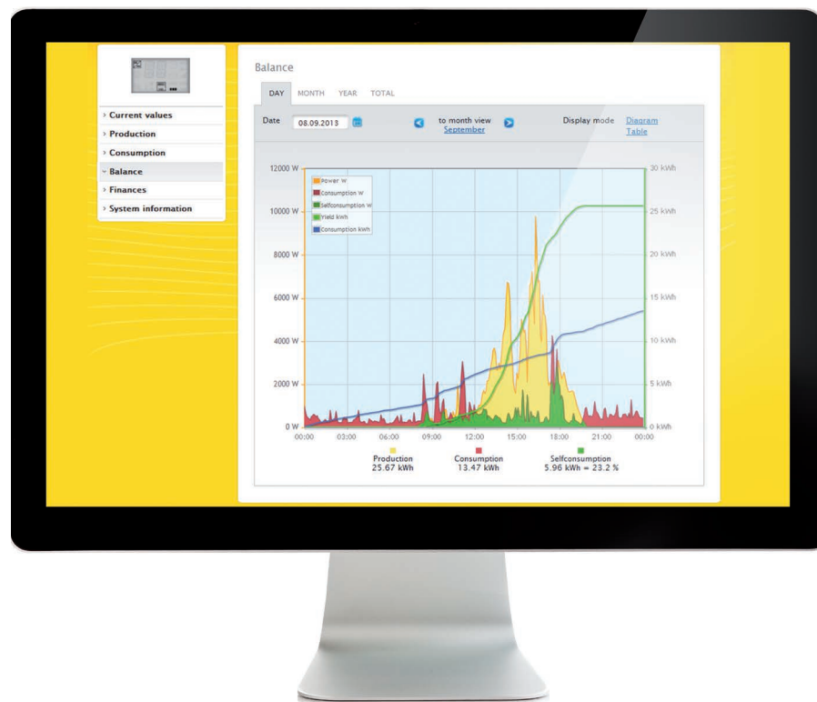
Unter „Bilanz“ wird die Erzeugung und der Verbrauch der PV-Anlage in Relation zueinander gezeigt. / The generated output and the consumption of the PV plant are displayed in the “Balance” section.
